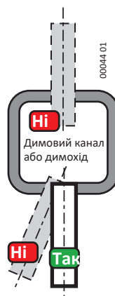
Ф.10 - Вхід випускної труби в димохід/димову трубу
